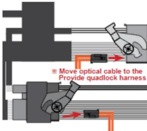
**Schritt 9. Verbinden Sie die restlichen Kabel mit dem Funkgerät (Stecker)**
