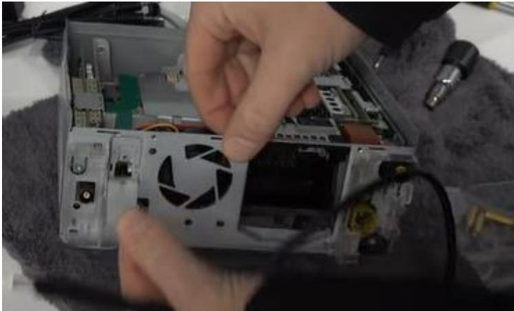
Entferne die Halterung neben der Entlüftung, um Platz für den Durchgang der beiden Kabel zu schaffen, die auf die Platine geklickt werden. Positionieren Sie auch die Antenne.
